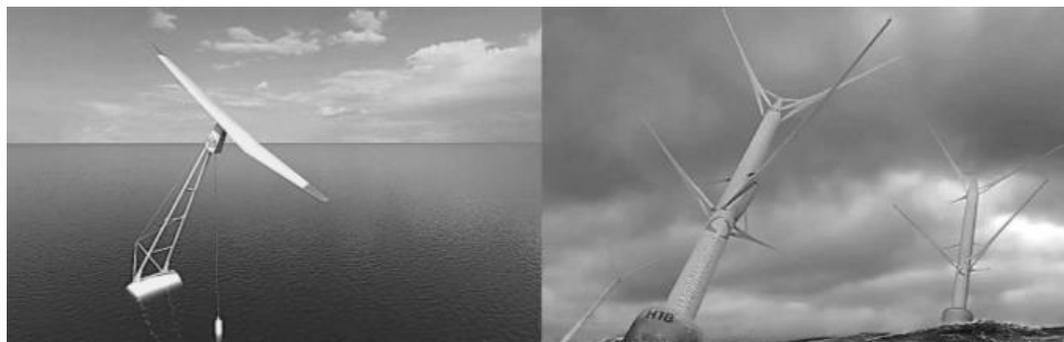
Рисунок 2.4 - Инновационный, адаптивный, плавающий ветрогенератор с причальным якорем: слева изображена турбина со сплошным наклонным ротором; справа – турбина с реверсивным вращением
