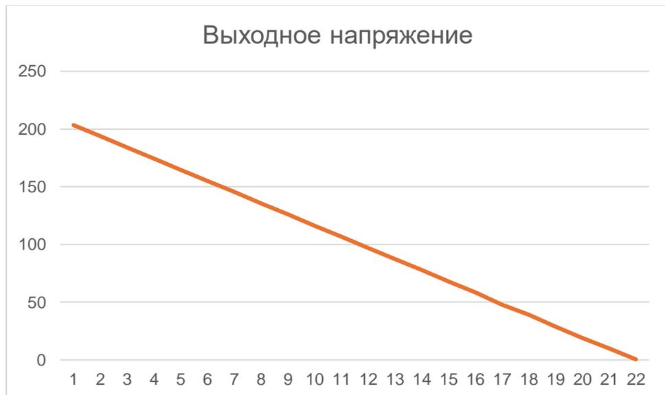
Рисунок 3.11 – График выходного напряжения  $U(I)$  от тока  $I$
